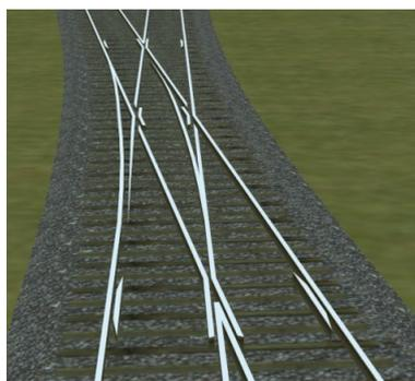
Eine einfache Kreuzungsweiche mit Abzweig nach links bietet drei Fahrmöglichkeiten je Fahrtrichtung: von links nach links, von links nach rechts und von rechts nach links.
