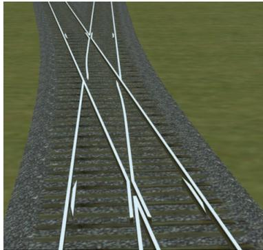
Eine stellbare Kreuzung ist eine Sonderform der reinen Kreuzung, bei der die Herzstücke in der Mitte durch Weichenungen ersetzt wurden, da die Herzstücklücken bei kleinen Kreuzungswinkeln sonst zu lang werden.
